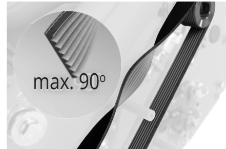
Abb. 14J – Korrekte Spannung bei 90° Riemenverdrehung.
