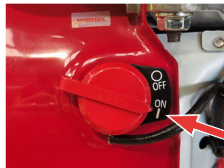
Abb. 12B – Motor einschalten.
