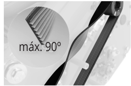
Fig. 14J - La presión correcta se alcanza cuando la correa gira longitudinalmente 90°
