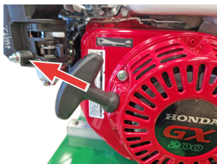
Fig. 12G - Tirar del tirador de la manija del arranque
