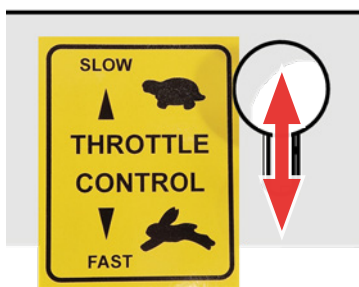
Fig. 15D - Ajustar la palanca del acelerador
