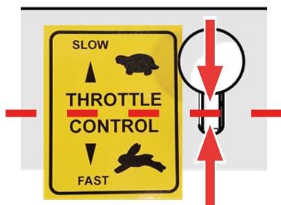
Fig. 12F - Palanca del acelerador en la posición intermedia
