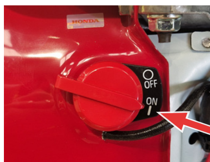
Fig. 12B - Interruptor del motor en la posición de encendido
