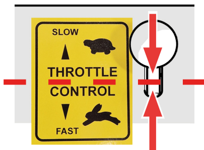
Fig.7F - Accélérateur en position intermédiaire.
