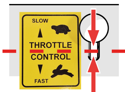
Fig. 7F - Acceleratore impostato in posizione intermedia.
