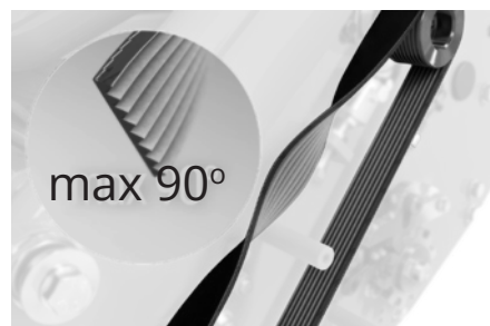
Fig. 16K - Pressione corretta raggiunta quando la cinghia si torce di 90°
