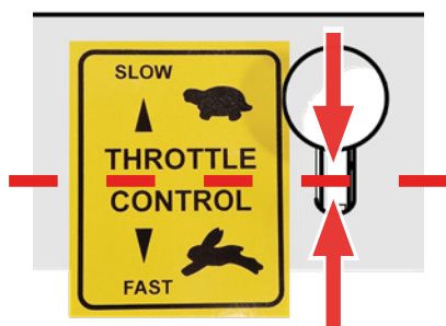
Fig. 12F - Acceleratore impostato in posizione intermedia
