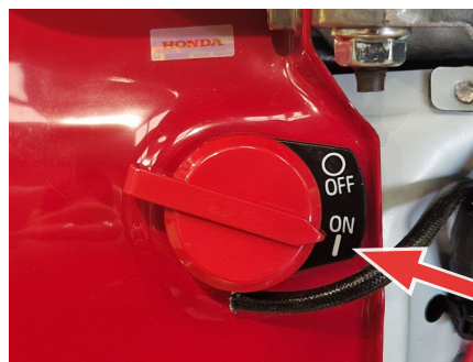
Fig. 7B – Interruptor do motor na posição "on" [Ligado].
