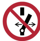
Não alterar o estado do interruptor
