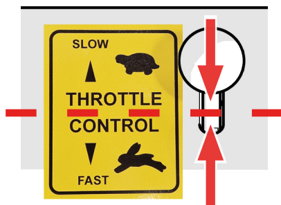
Fig. 7F – Acelerador colocado na posição intermédia.
