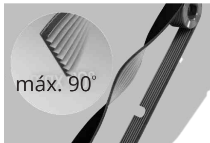
Fig. 18H - Comprobar la magnitud de la tensión de giro.
