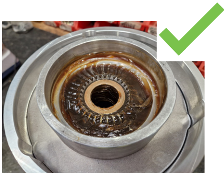
Fig. 25O - Correct grease amount.
