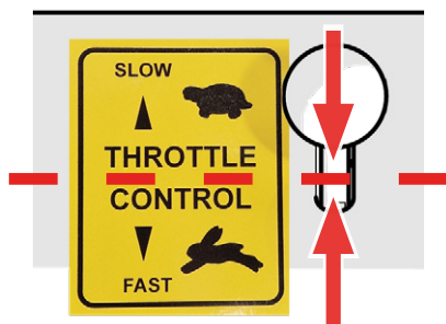
Rys. 9F — Dźwignia przepustnicy w położeniu środkowym
