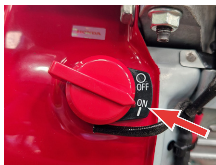
Rys. 9B — Włącznik silnika w położeniu włączonym
