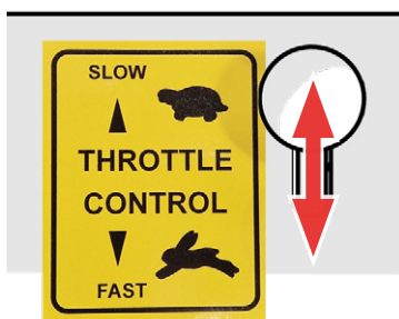
Rys. 12D — Regulacja dźwigni przepustnicy
