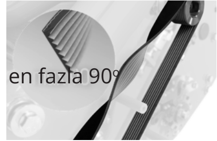
Şekil 13K - Kayış 90° döndüğünde doğru basınç sağlanır.
